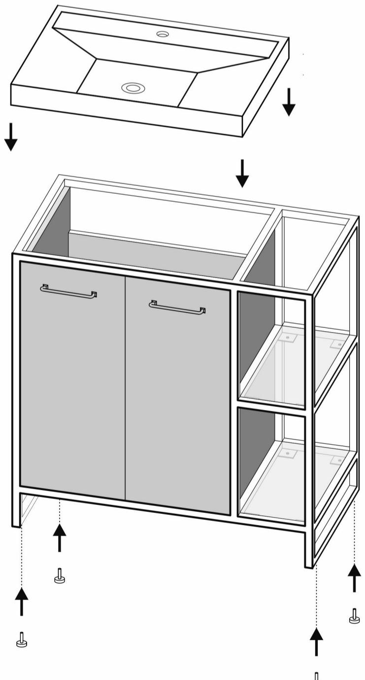
2. Установить тумбу на предполагаемое место эксплуатации и с помощью регулировки опор выровнять тумбу по горизонтальной плоскости.
